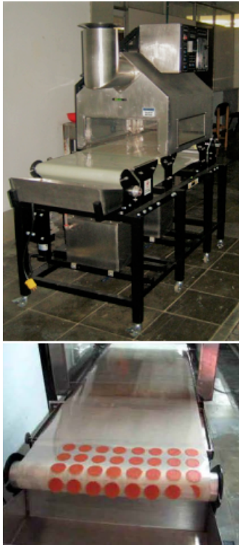
Слика 6.133: Илустрација лабораторијске инсталације за сушење материјала према концепту RW технологије. [141]
