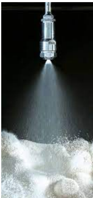
Слика 6.44: Илустрација млазнице за распршивање течног материјала у раду. [94]
