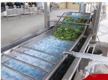
Слика 1.69: Илустрација машине за бланширање поврћа у кључалој води и хлађењем помоћу прскања хладном водом.
