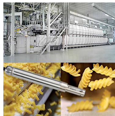
Слика 6.122: Илустрација вишезонске коморе и сонде за мерење влажности у комори. [135]
