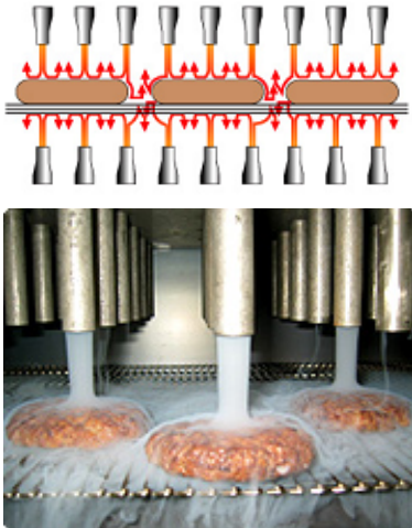
Слика 6.115: Илустрација распореда млазница изнад и испод материјала који се налази на перфорираној подлози. [131]
