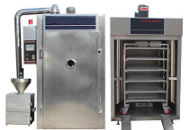
Слика 6.111: Илустрација индустријске коморе за димљење и сушење меса и рибе. [130]
