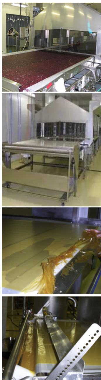
Слика 6.130: Илустрација изгледа и рада сушаре са RW технологијом.[140]
