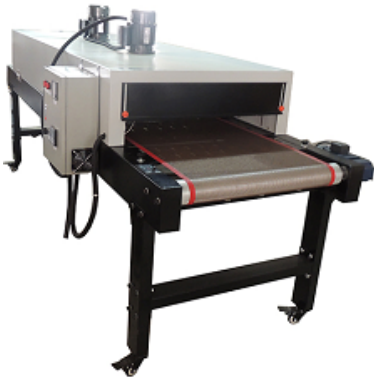
Слика 6.17: Илустрација тракасте сушаре. [78]
