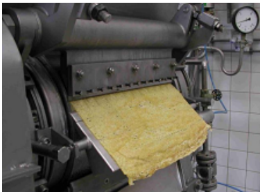
Слика 6.54: Илустрација скидања/стругања материјала са добоша сушаре. [99]
