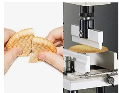
Слика 1.21: Илустрација акустичне емисије и одговарајућег начина њеног мерења на специјализованој мерној опреми.[6]
