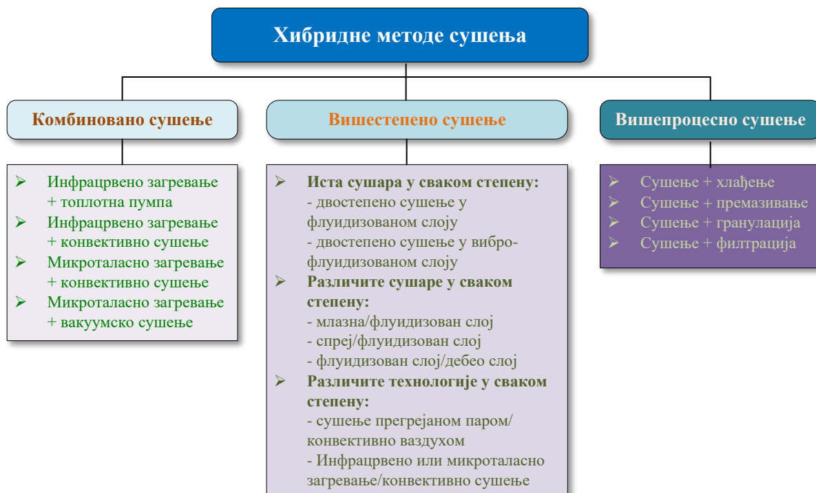
Слика 6.134: Класификација хибридних сушара које се најчешће срећу у пракси.
