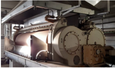
Слика 6.53: Илустрација добошасте сушаре са два добоша. [98]
