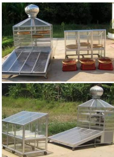
Слика 6.77: Илустрација различитих модела соларних кабинет сушара. [111]
