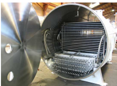
Слика 6.56: Илустрација лиофилизационе сушаре са кондензатором. [100]
