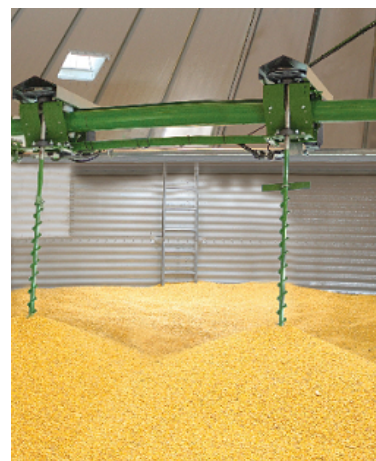
Слика 6.10: Илустрација мешања гомиле зрнастог материјала унутар коморе. [74]
