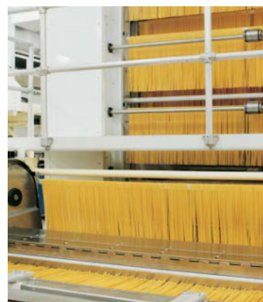
Слика 6.123: Илустрација сталка за транспорт шпагета кроз сушару. [136]
