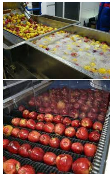
Слика 1.68: Илустрација аутоматизованог прања и чишћења јабука на четкама.
