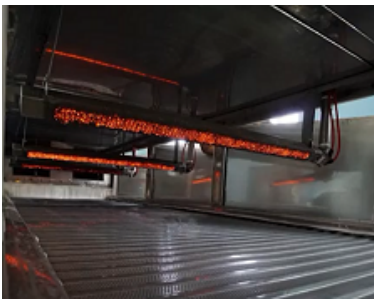
Слика 6.104: Илустрација примене гасних инфрацрвених грејача у сушарама са транспортером. [129]
