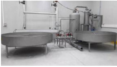
Слика 6.66: Илустрација осмотске сушаре са отвореним кадама.[108]
