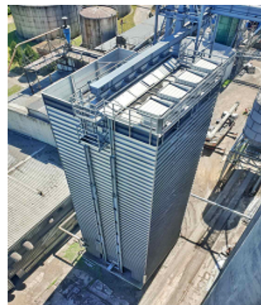
Слика 6.26: Изглед шахтне сушаре Strahl 17000 FAV/12. [82] Капацитет сушења: Кукуруз 70,0 t/h (28%-14% влажност); Соја 92,9 t/h (18%-13% влажност); Пшеница 129,0 t/h (20%-14% влажност).
