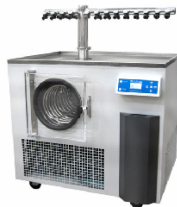
Слика 6.60: Илустрација фармацевтске лиофилизационе сушаре са издвојеном комором за кондензацију и прикључном рампом за посуде које ће се вакуумирати. [104]
