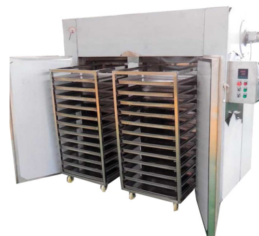
Слика 6.6: Илустрација мале коморне сушаре са лесема поређаним на двоје колица.
