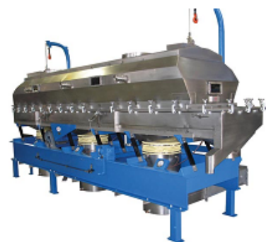
Слика 6.40: Изглед сушаре са вибро-флуидизованим слојем материјала. [92]
