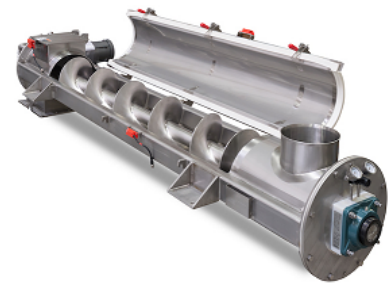
Слика 6.22: Илустрација сушаре са пужним транспортером. [80]
