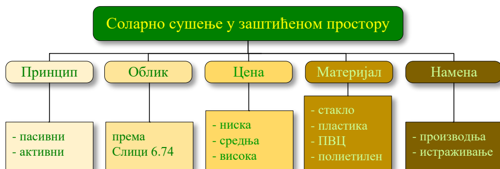
Слика 6.76: Класификација различитих типова заштићених простора који се користе при соларном сушењу. [109]
