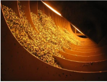
Слика 6.103: Илустрација примене електричних инфрацрвених емитера у ротационим сушарама. [128]
