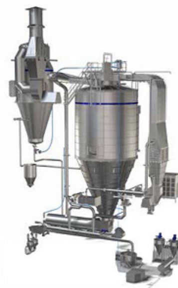
Слика 6.48: Илустрација спреј сушаре. [95]
